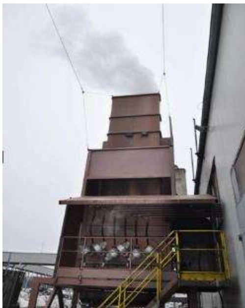
Слика бр. 9. Уређај за дистрибуцију водене паре
